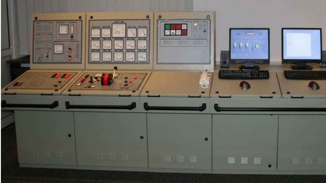
Fig. 4. MED3Dh - konsola sterowania silnikiem głównym.
